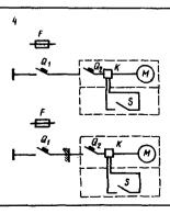
$Q_2$  и «K» встроены в оборудование, поставляются комплектно с оборудованием; S установлен на оборудовании
